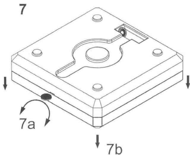
Öffnen der Leuchte durch abziehen der Wanne oder mit Münze an vorgesehenem Schlitz abheben.
