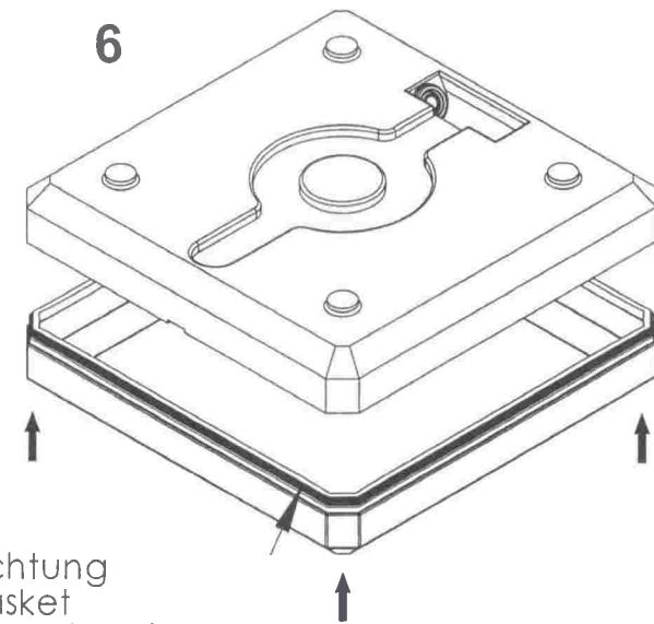
Das Schließen der Wanne kann durch Befeuchten der Dichtung erleichtert werden.
